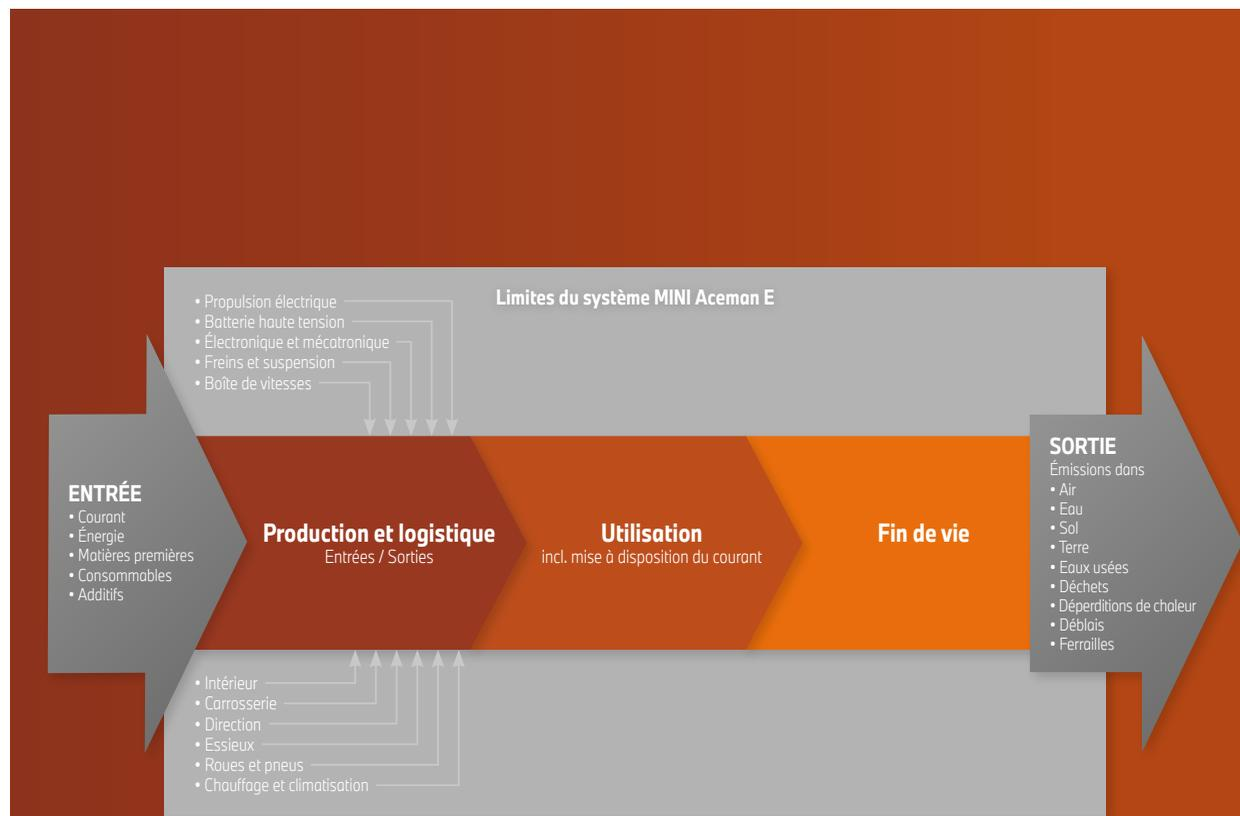
Fig. 1 : Limites du système de l'écobilan MINI Aceman E
